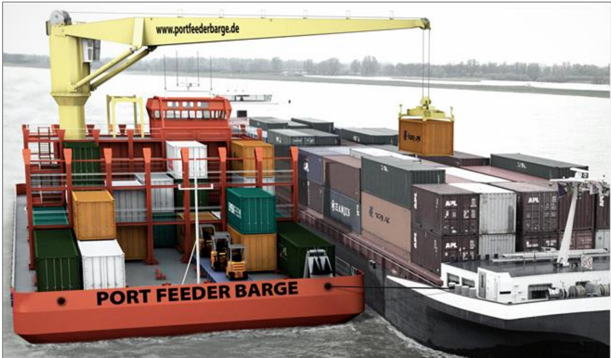
Abb. 3: "Port Feeder Barge" schlägt direkt auf ein Binnenschiff um
